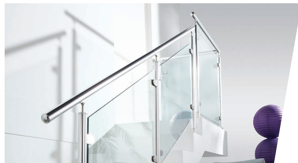
GAlu P-VVT - Éléments aluminium : poteaux ( embases plates ) et mains courantes Ø 40 mm. Verres toute hauteur en vitrage de sécurité 8,76 mm.
