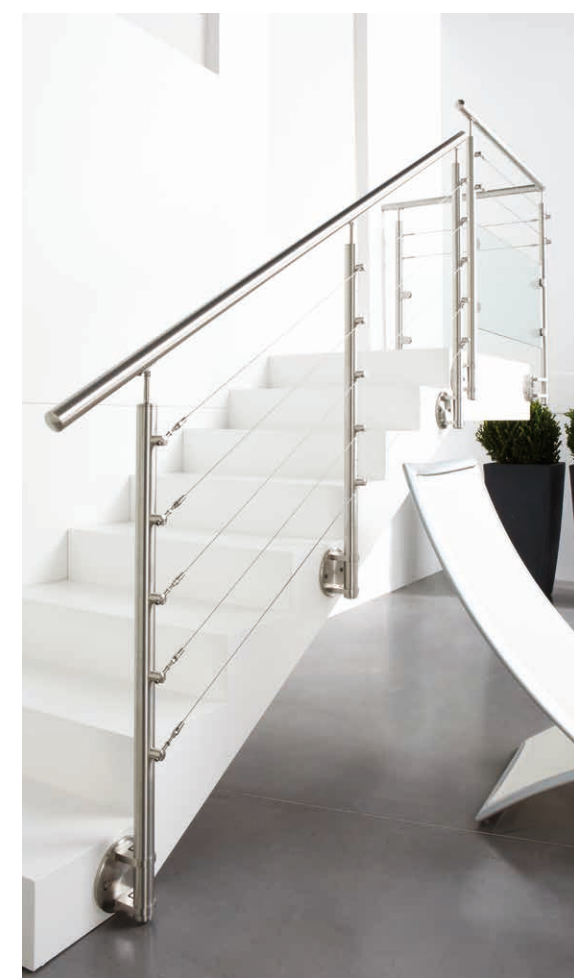
GInox L-CVP - Éléments inox : poteaux ( embases latérales ) et mains courantes \varnothing 42,4 mm, câbles \varnothing 3 mm. Partie basse des garde-corps droits en vitrage de sécurité 8,76 mm.
